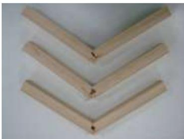
**Figura 2** – Corpos de prova de *Eucalyptus grandis* após a realização dos testes de resistência ao impacto.
